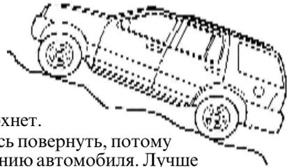
Если двигатель заглохнет, не пытайтесь повернуть, потому что это может привести к опрокидыванию автомобиля. Лучше добраться задним ходом до безопасного места.
