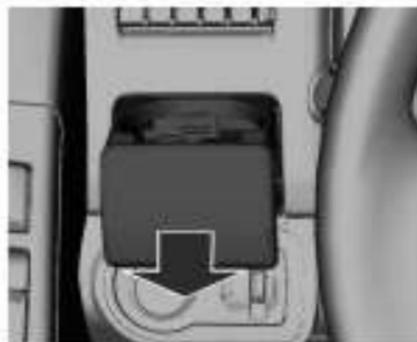
Складные подстаканники размещены под соплами вентиляции по бокам панели приборов. Потяните его, чтобы открыть.
