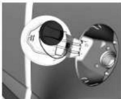
Пробку топливозаправочной горловины на время заправки можно закрепить на внутренней стороне крышки.
