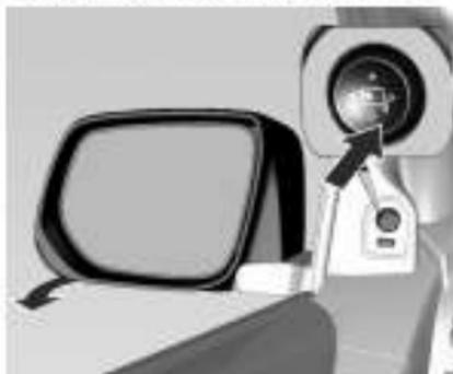
Установите переключатель выбора зеркал (левого или правого) в нейтральное положение **O**, а затем нажмите на нижний край выключателя регулировки положения. При этом оба наружных зеркала складываются.
