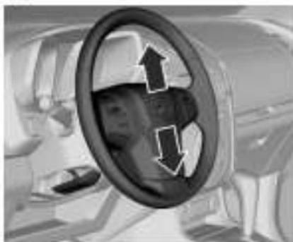
Разблокируйте рычаг, отрегулируйте положение рулевого колеса, затем верните рычаг в исходное положение и убедитесь, что он полностью заблокирован.
