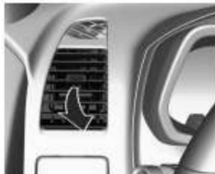
Отрегулируйте положение заслонок сопел вентиляции, чтобы изменить направление воздушного потока.
