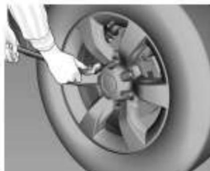
2. Вращая колесный ключ против часовой стрелки, ослабьте все гайки крепления колеса. Не сручивайте гайки полностью.
