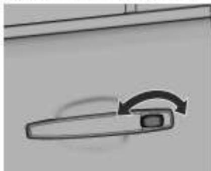
Поверните ключ против часовой стрелки.
