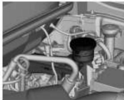
Уровень тормозной жидкости должен быть между отметками **MIN** и **MAX**.
