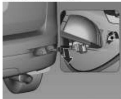
1. Открутите расположенный на обратной стороне бампера винт крепления фонаря и отсоедините электрический разъем.
