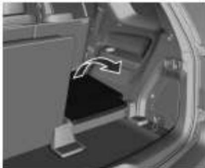
Потяните за ляжку, чтобы поднять спинку в вертикальное положение до срабатывания фиксатора.
