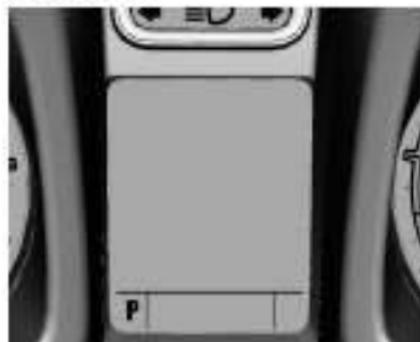
Данные о режиме работы и выбранной передаче КПП отображаются на центральном дисплее на панели приборов.
