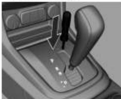
3. Вставьте отвертку в отверстие, чтобы разблокировать рычаг селектора, и переместите рычаг из положения **P** в положение **N**.
