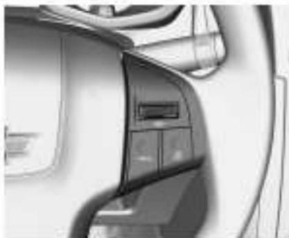
С помощью установленных на рулевом колесе органов управления можно управлять круиз-контролем. Круиз-контроль  $\Phi$  181.
