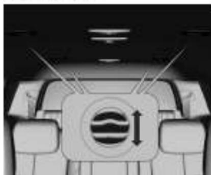
Охлаждаемый дополнительной системой кондиционирования воздух подается в заднюю часть салона через сопла, расположенные на обивке крыши автомобиля.
