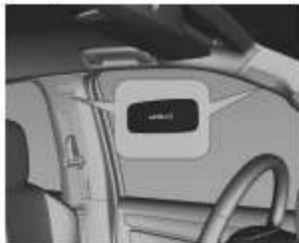
Система шторок безопасности включает подушки безопасности, установленные в раме крыши с каждой стороны. О наличии этих подушек свидетельствует надпись **AIRBAG** на стойках кузова.
