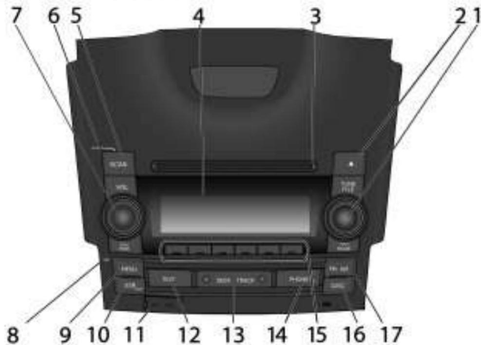
Тип 1: радио + CD/MP3 + AUX + USB + Bluetooth® в корпусе стандарта 2DIN
