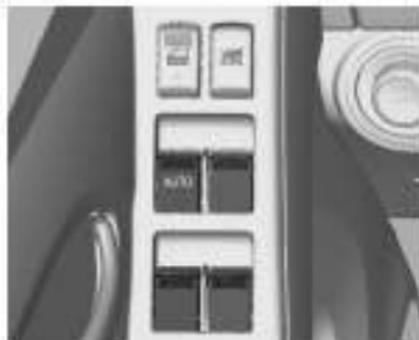
Потяните или нажмите клавишу выключателя стеклоподъемника, чтобы поднять или опустить стекло. Выключатель стеклоподъемника двери водителя имеет
