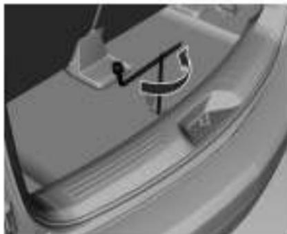
4. Вращайте колесный ключ против часовой стрелки, чтобы опустить запасное колесо на землю. Продолжайте вращать ключ, пока колесо не опустится настолько, чтобы его можно было извлечь из-под автомобиля.
