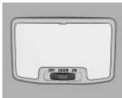
При посадке в автомобиль или высадке из него плафоны подсветки салона автоматически включаются и через короткий промежуток времени снова гаснут. Они загораются на короткое время, даже если водитель вынимает ключ из замка зажигания.
