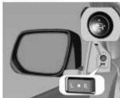
Сместите переключатель в положение **L** (левое) или **R** (правое), чтобы переключить управление на зеркало со стороны водителя или пассажира. Отрегулируйте положение зеркала, нажимая на края выключателя.
