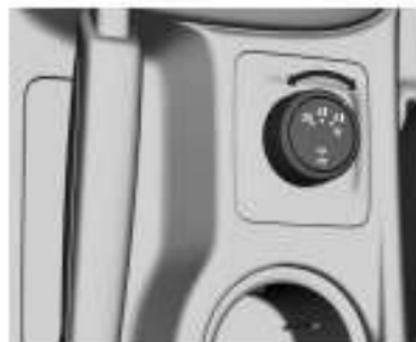
Вращая этот переключатель, можно включить или отключить полный привод. Переключатель может быть установлен в одно из следующих положений:
