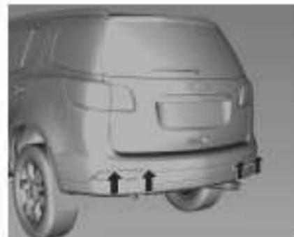
Система помощи при парковке облегчает парковку автомобиля путем измерения расстояния от автомобиля до расположенных сзади препятствий и подачи звуковых сигналов. Однако это ни в коей мере не снимает с водителя ответственность за маневрирование при постановке автомобиля на стоянку. Работу системы обеспечивают четыре ультразвуковых датчика в заднем бампере.
