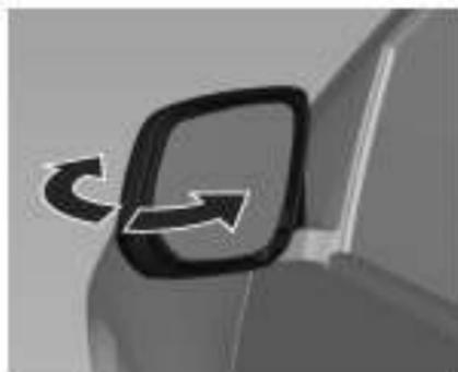
Для обеспечения безопасности пешеходов внешние зеркала складываются от удара определенной силы. Чтобы вернуть зеркало в рабочее положение, нужно слегка надавить на его корпус.
