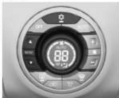
Для настройки требуемой регулировки необходимо нажать кнопку **MODE** один или более раз, настройка распределения воздуха отображается на информационном дисплее.
