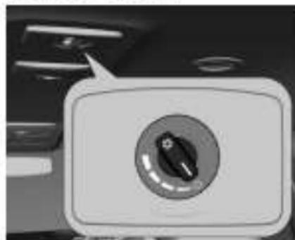
Вентилятор системы кондиционирования задней части салона автомобиля направляет поток воздуха в заднюю часть салона автомобиля через задние сопла обдува.
