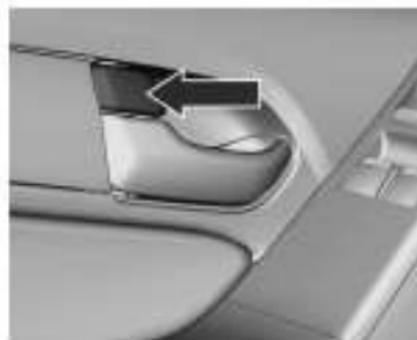
Нажмите на клавишу дополнительной блокировки замка соответствующей двери. Замок соответствующей двери заблокируется.
