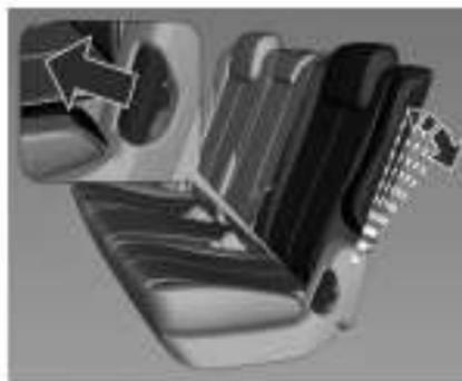
Потяните рычаг, отрегулируйте наклон спинки и отпустите рычаг, чтобы зафиксировать спинку в новом положении.
