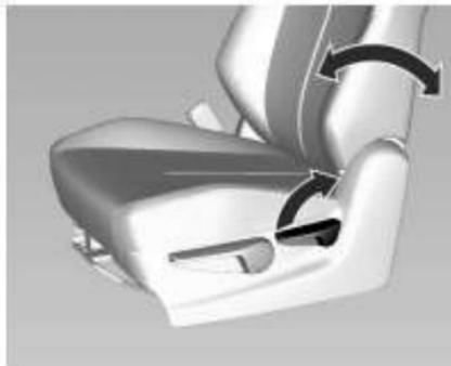
Потяните рычаг, отрегулируйте наклон и отпустите рычаг. Сиденье должно зафиксироваться в новом положении.
