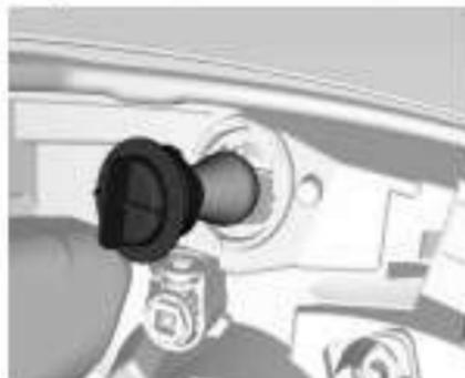
2. Слегка надавите на лампу, поверните ее против часовой стрелки и извлеките из патрона.
