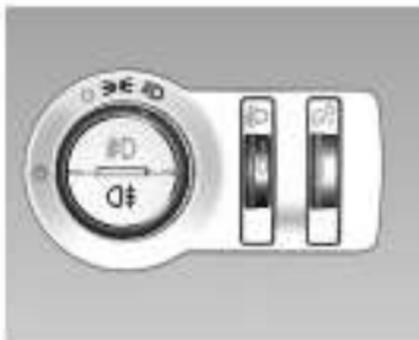
Включаются клавишей 0#. Переключатель световых приборов в положении #D или включены задние противотуманные фары.
