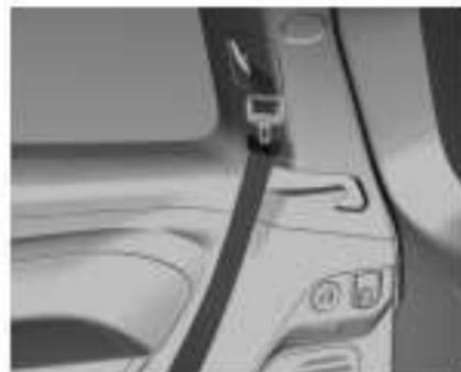
Закрепите ремни безопасности в скобах, чтобы они не мешали в процессе раскладывания сидений третьего ряда.
