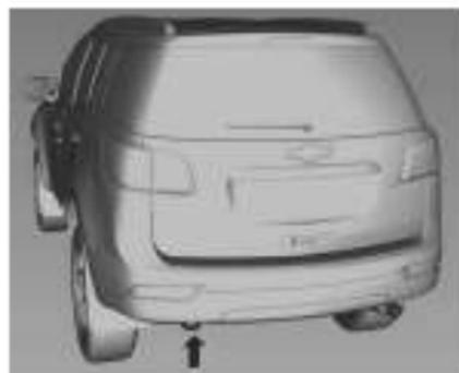
Буксирная проушина расположена в задней части автомобиля.
