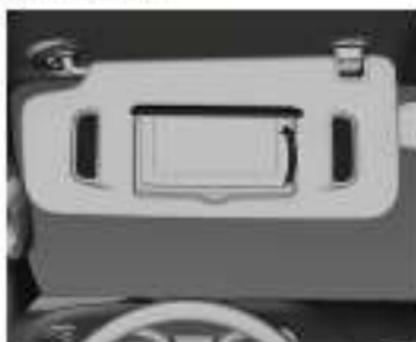
Загорается при откидывании крышки зеркала в солнцезащитном козырьке  $\varnothing$  36.
