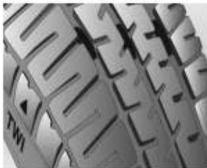
Шины также подлежат обязательной замене при износе протектора до высоты 1,6 мм. На иллюстрации показано, как измерить высоту протектора.
