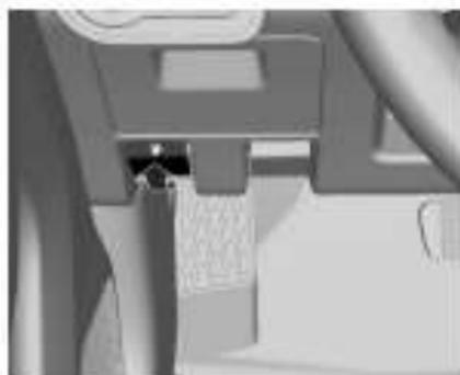
Чтобы открыть крышку люка заливной горловины, потяните клавишу ее разблокировки.
