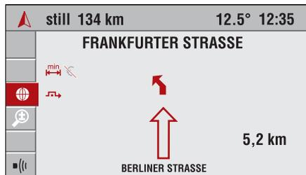
Кроме того, на экране в качестве предварительной подсказки появляется стрелка-указатель направления следующего поворота, даже если до этого поворота еще далеко.
