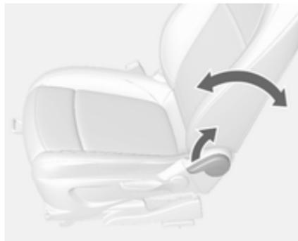
Потяните рычаг, отрегулируйте наклон и отпустите рычаг. Спинка сиденья должна зафиксироваться в новом положении с характерным щелчком.
