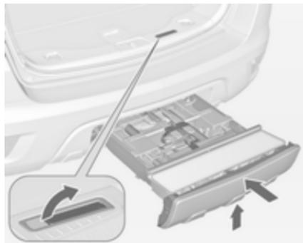
Нажмите вверх и удерживайте рычаг фиксатора. Слегка приподнимите каретку и задвиньте ее в бампер до фиксации.
