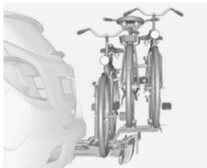
Задняя система перевозки грузов (система Flex-Fix) позволяет закрепить один велосипед на выдвижном держателе, встроенном в пол автомобиля. С помощью дополнительного кронштейна можно закрепить еще два велосипеда. Транспортировка других объектов запрещена.
