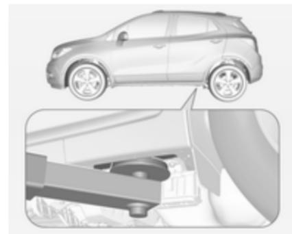
Задний рычаг подъемной платформы располагают по центру подпазом порога кузова.
