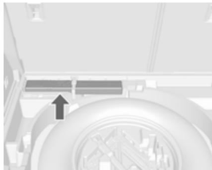
Знак аварийной остановки следует хранить в багажном отделении под крышкой пола. Закрепите ремнем.
