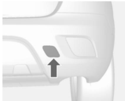
Подденьте крышку отверткой и снимите ее.
