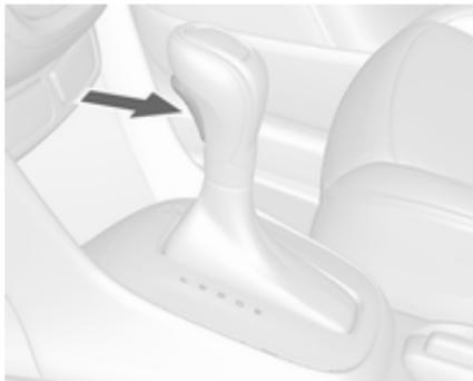
Чтобы включить передачу **P** или **R**, следует нажать кнопку освобождения.
