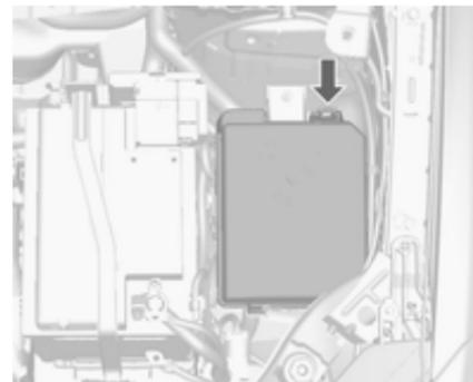
Блок предохранителей находится в моторном отсеке.
