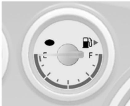
В зависимости от режима работы показывает уровень топлива в баке или газа в баллоне.
