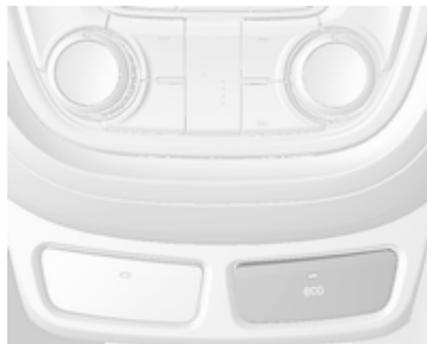
Чтобы принудительно отключить систему автоматической остановки и пуска двигателя, нажмите клавишу **eco**. При отключении системы светодиод подсветки клавиши гаснет.
