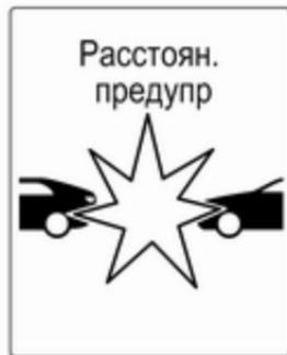
При быстром сближении с другим транспортным средством на дисплее информационного центра водителя отобразится меню системы предупреждения о столкновении. Одновременно раздается предупреждающий звуковой сигнал. Выжмите педаль тормоза, если этого требует ситуация.
