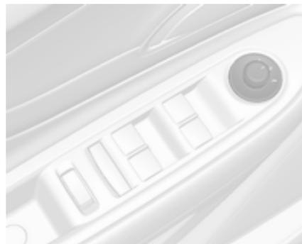
Выберите нужное наружное зеркало поворотом переключателя влево (**L**) или вправо (**R**). После этого отрегулируйте положение зеркала, изменяя положение рычага выключателя.
