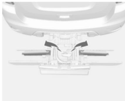
Отсоедините ремешок и откиньте в стороны опоры для колес.
