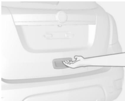
Чтобы открыть заднюю дверь багажного отделения, после отпирания замков дверей нажмите на сенсорную панель и потяните дверь.
