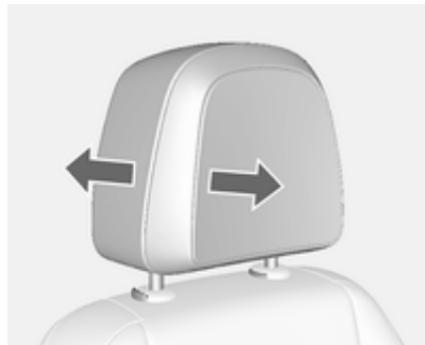
Чтобы отрегулировать положение подголовника в горизонтальном направлении, сдвиньте его вперед. Он имеет три фиксированных положения.
