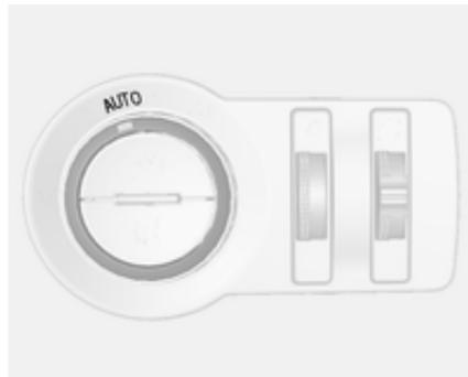
Если включен режим автоматического управления осветительными приборами и двигатель работает, переключение между дневными ходовыми огнями и ближним светом осуществляется автоматически в зависимости от внешних условий освещения.
