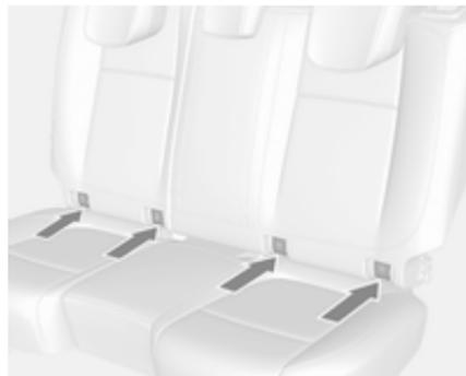
Перед крепежными скобами могут быть расположены направляющие, помогающие установить детское удерживающее устройство. Крышки направляющих откидываются автоматически при установке детского удерживающего устройства.
