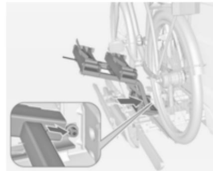
1. Установите дополнительный кронштейн на каретку задней системы перевозки грузов, как показано на иллюстрации.
