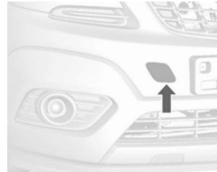
Подденьте крышку отверткой и снимите ее.
