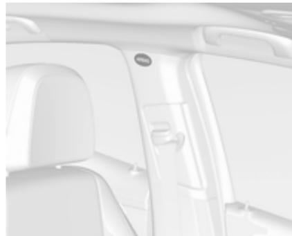
Система подушек безопасности головы срабатывает в случае бокового удара при достаточно серьезной аварии. Зажигание должно быть включено.
