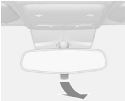
Для уменьшения бликов поверните рычаг на нижней части корпуса зеркала.
