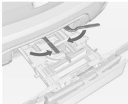
Поверните оба фиксирующих рычага внутрь, насколько это возможно. Закрепите ремень.
