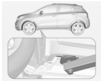
Место установки передней лапы подъемника на днище кузова.
