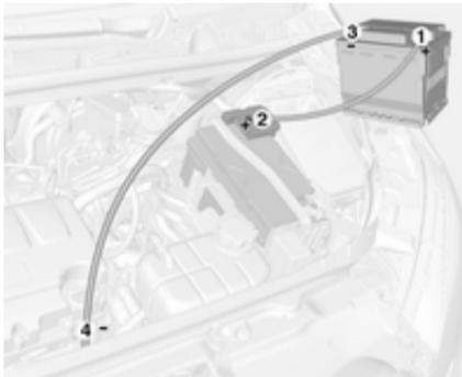
Порядок подключения проводов:
