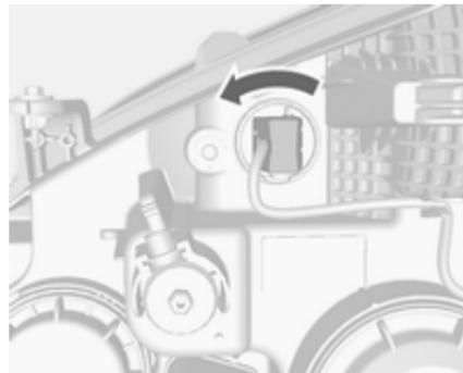
1. Поверните патрон лампы против часовой стрелки и выньте его.
