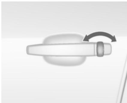
Разблокируйте дверь водителя вручную, повернув ключ в замке. Чтобы отпереть замки всех остальных дверей, багажника и откидной крышки заправочной горловины топливного бака, следует включить зажигание и нажать кнопку центрального замка
