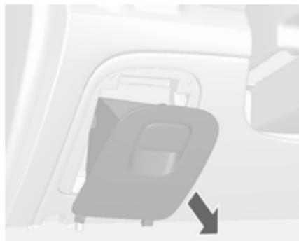
Внутренний блок предохранителей расположен под приборной панелью на стороне водителя.
