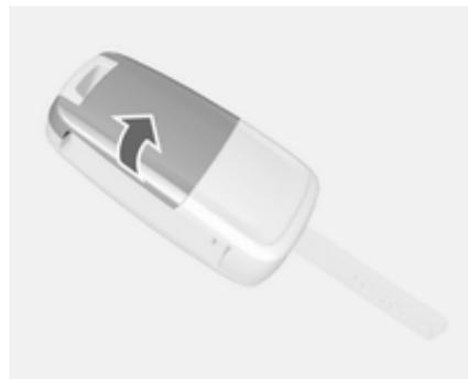
Раскройте ключ и откройте корпус. Замените батарейку (тип CR 2032), обращая внимание на ее правильное положение при установке. Закройте пульт и выполните синхронизацию.
