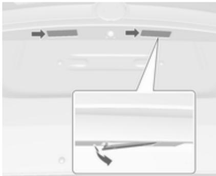
1. Отсоедините светильник с помощью отвертки.
