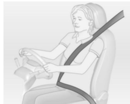
Ремни безопасности сиденья блокируются при резком разгоне или замедлении автомобиля, удерживая пассажиров в сидячем положении. Тем самым существенно снижается опасность получения травмы.
