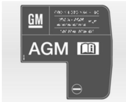
AGM-аккумулятор имеет специальное обозначение на корпусе. Рекомендуется использовать фирменные аккумуляторы компании Opel.
