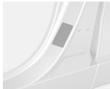
Давление в шинах  $\varnothing$  230 и на табличке на дверном проеме водителя.
