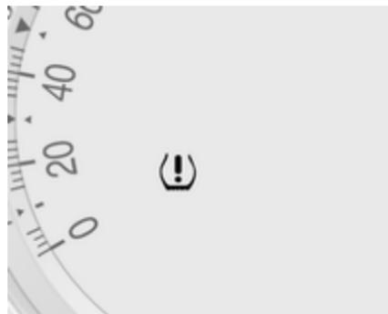
При выявлении низкого давления воздуха в шинах загорается индикатор (!). Как можно скорее остано-
