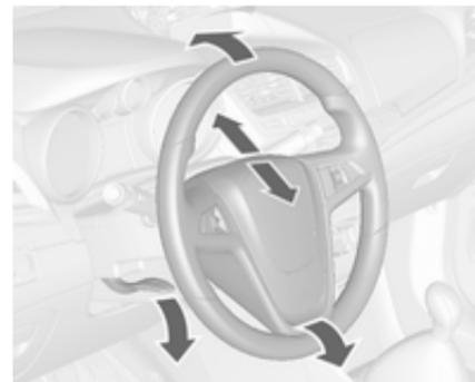
Разблокируйте рычаг, отрегулируйте рулевое колесо, затем заблокируйте рычаг и убедитесь, что он полностью зафиксирован.
