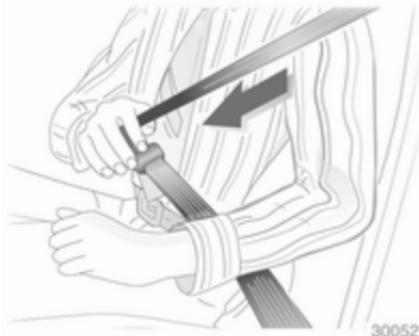
Вытяните ремень безопасности из подматывающего механизма, не перекручивая, перекиньте его поперек туловища и вставьте язычок защелки в пряжку.
