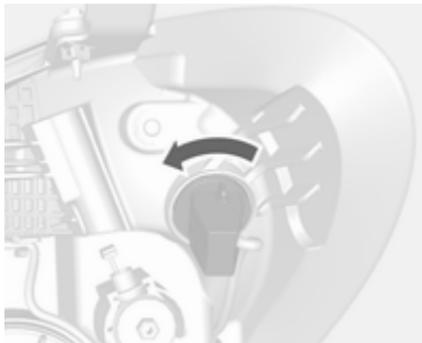
1. Извлеките патрон лампы из блок-фары, повернув его против часовой стрелки.
