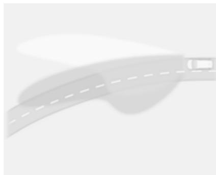
В зависимости от положения рулевого колеса и скорости движения происходит поворот светового луча, чем достигается улучшенная освещенность полотна дороги во время прохождения поворота.
