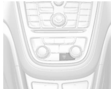
Включается при нажатии кнопки
