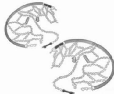
Используйте цепи противоскольжения только на передних колесах. Установка колесных цепей допускается только на колесах типоразмера 195/70 R16.
