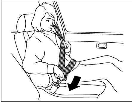
2. Медленно вытяните ремень из инерционной катушки и вставьте запорную скобу в замок до щелчка.
