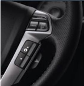
Когда условия движения позволяют использовать крузи-контроль, можно включить его нажатием одной кнопки на рулевом колесе.
