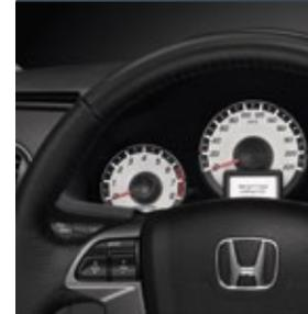
Приборная панель с подсветкой и дорожным компьютером на русском языке мгновенно предоставляет информацию о скорости, расходе топлива и расстоянии, которое можно проехать без дозаправки. Она содержит индикаторы, компас, указатель наружной температуры и двойной одомер, а так же позволяет измерять и обнулять время движения.
