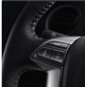
Кнопки на рулевом колесе обеспечивают управление воспроизведением музыки: функции регулировки громкости, выбора записей и радиостанций всегда под рукой.
