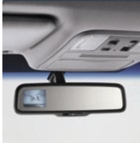
Установленная сзади миниатюрная камера отображает пространство за автомобилем. Создаваемое изображение демонстрируется на экране, установленном в зеркале заднего вида в комплектации Executive или на экране навигационной системы в комплектации Executive + NAVI.
