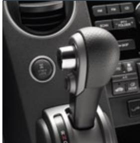
Установленный на передней панели автоматический селектор с технологией Grade Logic смягчает переключение передач.
