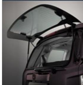
Окно задней двери откидывается вверх нажатием одной кнопки для обеспечения удобства доступа в багажное отделение без открытия задней двери.
