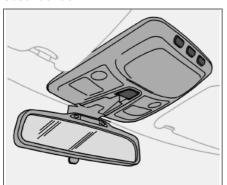
Напоминание пассажирам, не пристегнутым ремнями безопасности, подается в виде звукового и светового сигнала. Звуковое напоминание зависит от скорости. Световое напоминание расположено в потолочной консоли и комбинированном приборе. На низкой скорости звуковое напоминание подается первые шесть секунд.
