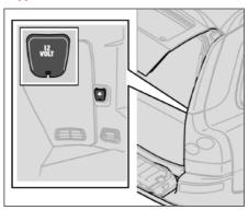
Для использования розетки откиньте крышку. Розетка находится под напряжением независимо от того, включено зажигание или нет.
