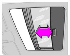
Люк в крыше снабжен управляемой вручную внутренней солнцезащитной шторкой. Когда люк открывается, солнцезащитная шторка автоматически сдвигается назад. Чтобы закрыть шторку, сдвиньте ее вперед за ручку.
