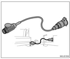
Если буксирное устройство автомобиля оборудовано 13-штекерным разъемом, а прицеп 7-штекерным разъемом, необходим специальный переходник. Используйте переходный кабель, одобренный Volvo. Проверьте, чтобы кабель не волочился по земле.
