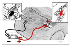
Если аккумуляторная батарея разрядилась, то для пуска двигателя можно "позаимствовать" ток от отдельного аккумулятора или аккумулятора другого автомобиля. Во избежание искрообразования при попытке пуска двигателя обязательно проверьте надежность крепления зажимов на пусковых проводах.
