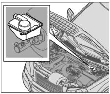
Жидкость сцепления и тормозов заливается в общий бачок<sup>1</sup>. Уровень должен находиться между отметками **MIN** и **MAX**. Регулярно проверяйте уровень. Заменяйте тормозную жидкость один раз в два года или во время каждого второго планового техобслуживания.
