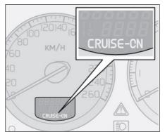
Увеличить или уменьшить зафиксированную скорость можно, нажав на + или –. Скорость автомобиля в момент отпускания кнопки программируется.
