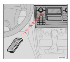
Направьте пульт дистанционного управления на ИК-приемник (см. рисунок), который расположен на приборной панели.
