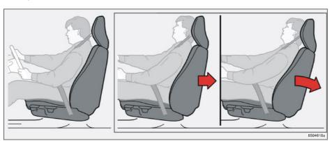
Система WHIPS (Whiplash Protection System) состоит из энергопоглощающей спинки и специально модернизированного для данной системы подголовника в передних креслах. Система активируется в момент удара сзади и ее срабатывание зависит от угла удара, скорости и вида транспортного средства, нанесшего удар.
