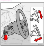
Положение рулевого колеса можно регулировать как по вертикали, так и по горизонтали. Нажмите на регулятор слева от рулевой колонки. Затем установите рулевое колесо в удобное для Вас положение. Отожмите обратно регулятор, чтобы зафиксировать руль. Если при этом возникают затруднения, нажмите слегка на руль, одновременно отжимая регулятор.
