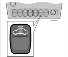
Можно временно отключать датчики движения и наклона для предотвращения случайного срабатывания сигнализации, например, из-за собаки, оставленной в автомобиле, или во время перевозки автомобиля на пароме.
