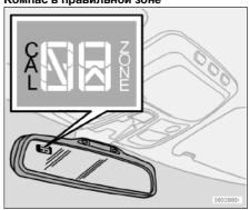
Земной шар делится на 15 магнитных зон. Компас настроен на тот географический регион, в который осуществлена поставка данного автомобиля. Если автомобиль перемещается через несколько магнитных зон, необходимо проводить калибровку компаса.
