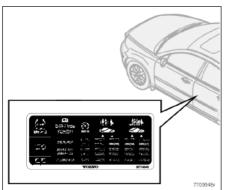
На наклейке, расположенной на дверной стойке на стороне водителя, указано давление в шинах при различной нагрузке и скоростях.
