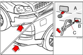
Буксирная скоба имеется в наборе инструментов в багажнике. При буксировке необходимо, чтобы Вы сами крепко закрутили буксирную скобу. Розетку и крышку для буксирной скобы Вы найдете на правой стороне соответствующего бампера.
