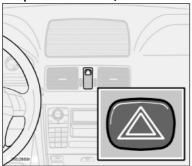
Аварийную мигающую сигнализацию (мигают все указатели поворотов) следует использовать, когда автомобиль останавливается в таком месте, где он создает опасность или помехи для других транспортных средств. Нажмите на кнопку для активирования данной функции.
