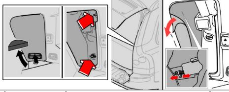
Пробка заливной горловины находится под крышкой на заднем крыле с правой стороны и ее можно навесить изнутри на крышке топливого бака.
