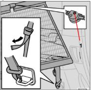
Защитную сетку можно свернуть и разместить под полом в багажнике (для пятиместного автомобиля).
