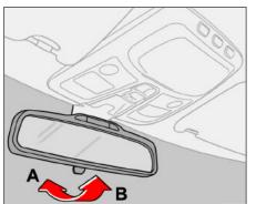
Данная иллюстрация является монтажом. Зеркало заднего вида имеет либо ручное, либо автоматическое противоослепление, но не может иметь обе функции одновременно.
