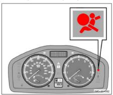
Работа системы AIRBAG<sup>1</sup> постоянно контролируется модулем управления системы. Предупреждающий символ в комбинированном приборе загорается после поворота ключа зажигания в положение I, II или III. Символ гаснет примерно через семь секунд, если система AIRBAG<sup>1</sup> исправна.
