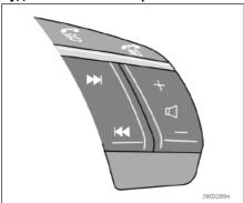
Четыре нижние кнопки на клавиатуре руля являются общими для радио и телефона. Функция кнопки зависит от того, какая система активирована. При помощи клавиатуры на руле Вы можете регулировать звук, переключаться между запрограммированными станциями и менять дорожку на компакт-диске.
