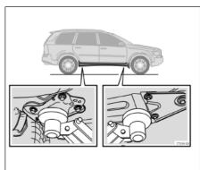
Если автомобиль поднимается на домкрате в мастерской, то подъемник следует устанавливать под передний край несущей рамы двигателя.
