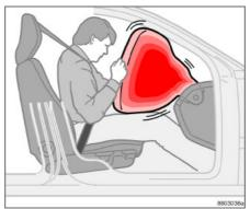
В дополнение к ремню безопасности автомобиль оснащен надувной подушкой безопасности SRS (Supplemental Restraint System). Надувная подушка безопасности на стороне пассажира 1 сложена над отделением для перчаток, на панели которого имеется маркировка SRS AIRBAG.
