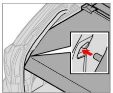
Вытащите тонированный экран, протяните его поверх багажа и закрепите на крюках в отверстиях задних стоек багажника.
