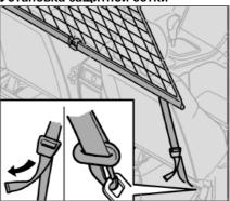
Если на автомобиле установлена защитная шторка, снимите ее перед установкой зашитной сетки.
