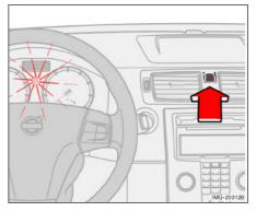
Аварийную мигающую сигнализацию (мигают все указатели поворотов) следует использовать, когда автомобиль останавливается в таком месте, где он создает опасность или помехи для других транспортных средств. Нажмите на кнопку для активирования данной функции.
