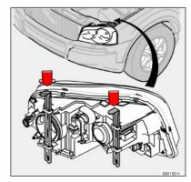
Установка на место вставки фары проводится в обратном порядке. Проверьте, чтобы фиксирующие штифты были вставлены правильно.
