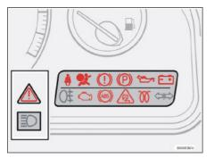
Все контрольные и предупреждающие символы<sup>1</sup> загораются после поворота ключа зажигания в положение ІІ перед пуском двигателя. Так проверяется функционирование символов. После пуска двигателя все символы должны погаснуть за исключением символа стояночного тормоза, который гаснет после отпускания тормоза.
