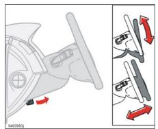
Рулевое колесо можно регулировать по высоте и в продольном положении.
