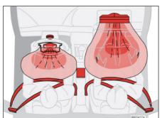
Система SRS. автомобиль с левосторонним управлением.
