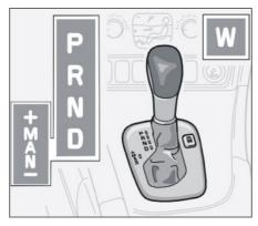
В положении **Р** коробка передач механически заблокирована. Всегда затягивайте стояночный тормоз при парковке.
