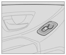
Окна задних дверей можно открывать и закрывать, как с помощью переключателя на соответствующей двери, так и с помощью переключателей на двери водителя. Если лампа в переключателе блокировки стеклоподъемников в задних дверях (расположенный на панели управления на двери водителя) горит, то окнами задних дверей можно управлять только при помощи переключателей на двери водителя.
