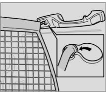
Защитная сетка предотвращает движение багажа и груза вперед в салон при сильных торможениях.
