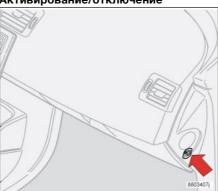
Переключатель PACOS (Passenger Airbag Cut Off Switch).
