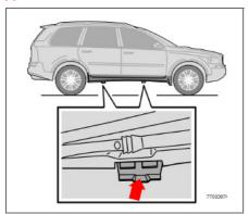
Если колесо необходимо заменить в местах с дорожным движением, не забудьте установить треугольный знак аварийной остановки. С каждой стороны в автомобиле имеется два углубления для установки домкрата, расположенные по центру под нижним краем дверей.
