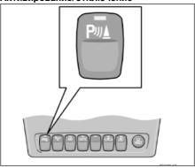
Помощь при парковке можно выключить кнопкой на панели переключателей, при этом светодиод в выключателе гаснет. Помощь при парковке восстанавливается с помощью выключателя, при этом включается светодиод.
