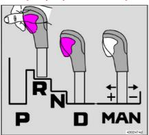
Вы можете всегда перемещать рычаг селектора передач свободно вперед или назад между положениями **N** и **D**. Другие положения имеют блокировку, которая управляется с помощью кнопки на рычаге селектора передач.
