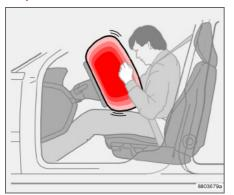
В дополнение к ремню безопасности автомобиль оснащен надувной подушкой безопасности SRS (Supplemental Restraint System) в рулевом колесе. Эта подушка сложена в центральной части рулевого колеса. Такое рулевое колесо имеет маркировку SRS AIRBAG.
