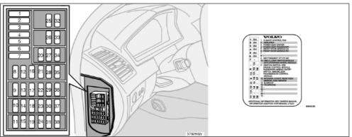
Наклейка с указанием позиции предохранителей и числа ампер расположена под крышкой торцевого блока.
