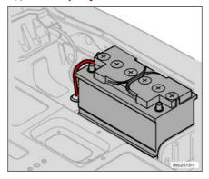
В аккумуляторе может образовываться очень взрывоопасный гремучий газ. Дренажный шланг отводит гремучий газ от аккумулятора за пределы автомобиля и предотвращает накопление газа в пассажирском салоне и багажнике. Если по какой-то причине Вы должны заменить аккумулятор, категорическим требованием является подсоединение дренажного
