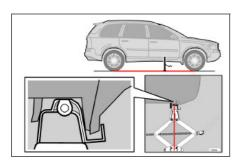
Установите домкрат под точки крепления и поднимите его до пола автомобиля. Перед подъемом автомобиля убедитесь, что домкрат установлен правильно.
