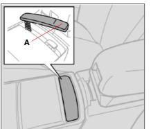
Если Вы хотите разговаривать без помех, используйте телефонную трубку. Поднимите трубку коротким нажатием на верхнюю часть (**A**).
