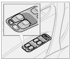
Автоматическое запирание активируется и отменяется с панели управления в двери водителя. Эта функция означает, что двери запираются автоматически на скорости выше 7 км/ч и остаются запертыми до тех
