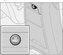
Электрическое гнездо можно использовать для подключения различного дополнительного оборудования, например, мобильного телефона или холодильника. Оно рассчитано на 12 В. Макс, сила тока 10 А. Напряжение на гнездо подается, если ключ зажигания находится, как минимум в положении I.
