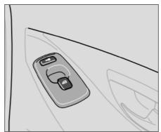
Переключатель электрического стеклоподъемника на переднем пассажирском месте управляет только этим окном.
