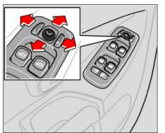
Переключатели для настройки двух наружных зеркал заднего вида находятся в передней части подлокотника на двери водителя. Зеркала заднего вида можно устанавливаться в положении зажигания I и II.
