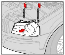
При замене ближнего и дальнего света фар, габаритных/стояночных огней необходимо снять всю вставку с лампами. Для замены одной из этих ламп проделайте описанное ниже, а затем посмотрите инструкции для соответствующей лампы.
