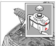
При заправке следуйте инструкциям на упаковке. Для определенной погоды важно выбрать правильное соотношение между количеством охлаждающей жидкости и воды. Никогда не добавляйте только воду. Стойкость к замерзанию снижается, как при недостаточном, так и избыточном количестве охлаждающей жидкости в смеси.
