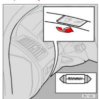
Освещение порогов расположено под приборной панелью на стороне водителя и пассажира.
