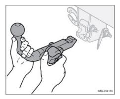
Поверните вниз до упора стопорную ручку и, удерживая ее, одновременно выньте шаровое устройство назад и вверх.
