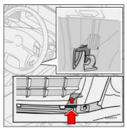
Для открытия запорного механизма капота двигателя потяните рукоятку на себя.
