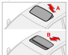
Органы управления люком в крыше расположены на потолке. Люк может открываться в два положения:
