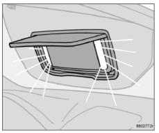
Лампа включается автоматически при подъеме крышки.
