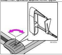
Используйте подходящий наконечник динамометрического ключа (см. рисунок) или стартовый ключ для снятия или закручивания защитной крышки. Поверните на јоборота.
