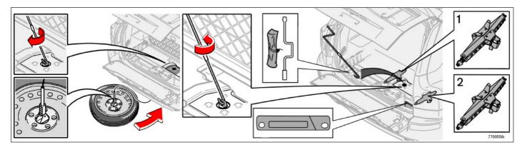
Запасное колесо расположено под автомобилем. Домкрат<sup>1</sup>, сумка с инструментами<sup>1</sup> и ручка находятся под крышкой в полу. Ручка состоит из двух частей. Одна часть находится в сумке с инструментами, а другая часть – под сумкой с инструментамии.
