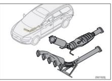
Катализатор предназначен для очистки отработанных газов. Он располагается в потоке этих газов вблизи двигателя, чтобы быстро достигалась рабочая температура. Катализатор представляет собой монолит (из керамики или металла), пронизанный каналами. Стенки каналов покрыты тонким слоем платины/родия/палладия. Эти металлы действуют как катализаторы, т.е. они ускоряют химические процессы, но сами не расходуются.
