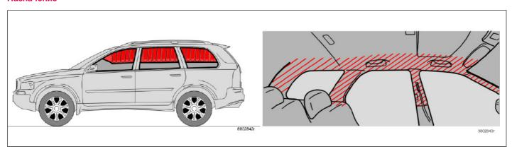
Надувной занавес IC (Inflatable Curtain) является дополнением к SIPS. Он установлен вдоль потолка с обеих сторон и защищает пассажиров на передних и задних сидениях. При достаточно сильном столкновении датчик реагируют, и занавес надувается. Он помогает защищать голову водителя и пассажиров от удара о внутреннюю поверхность автомобиля в момент столкновения.
