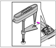
Следите за тем, чтобы багажник был точно придвинут к полозьям. Прочно зафиксируйте винтами багажник. Используйте приложенный динамометрический ключ и затяните до маркировки на ключе (соответствует 6 Нм). См. рисунок!
