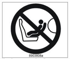
Наклейка на торце приборной панели.
