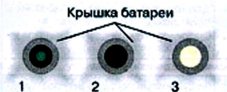
Рис. 1. Показания индикатора плотности электролита: 1 — темный индикатор с зеленой точкой — батарея заряжена; 2 — темный индикатор без зеленой точки — батарея разряжена; 3 — прозрачный или светло-желтый индикатор — низкий уровень электролита
